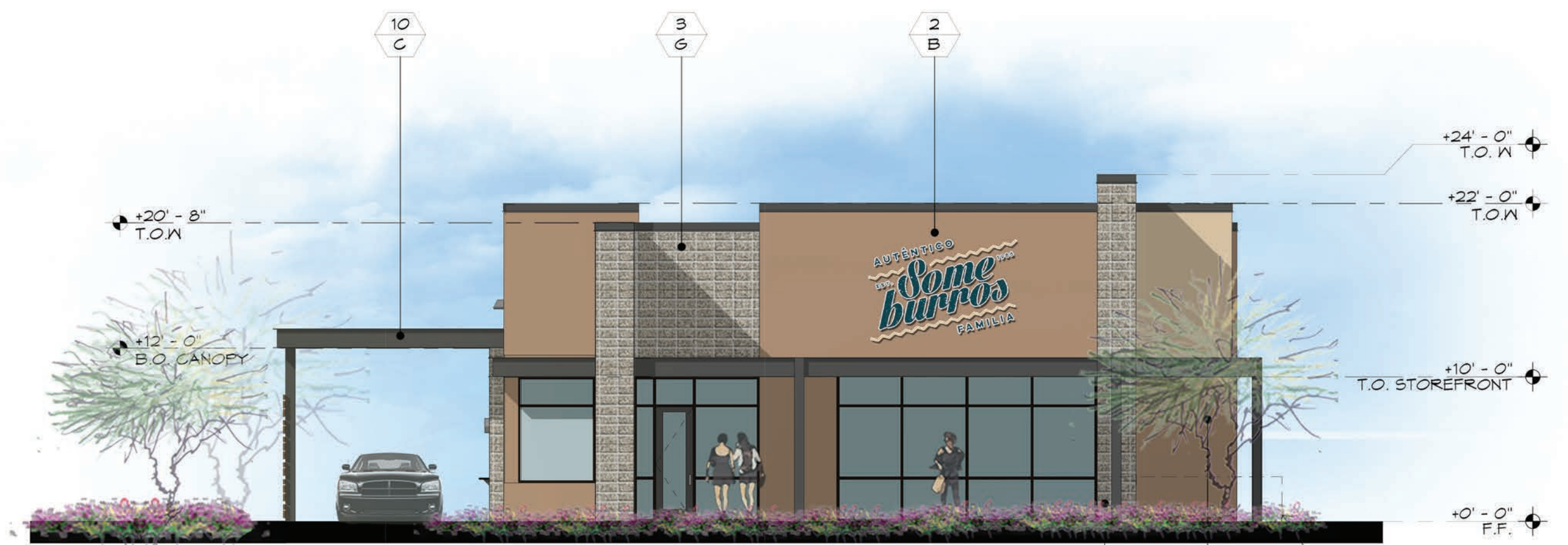
3 South Elevation SCALE: 1/8" = 1'-0"
